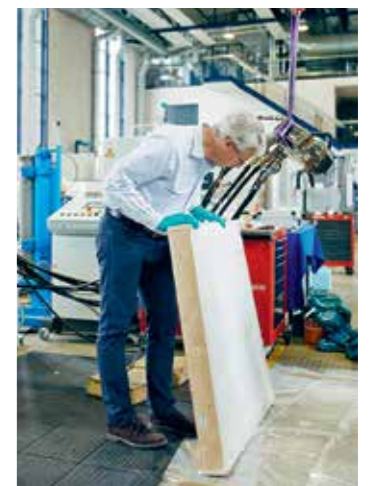
Von der Hülle zur Wand: Andreas Mohr begutachtet ein Hauselement, das mit Bauschaum gefüllt wird
